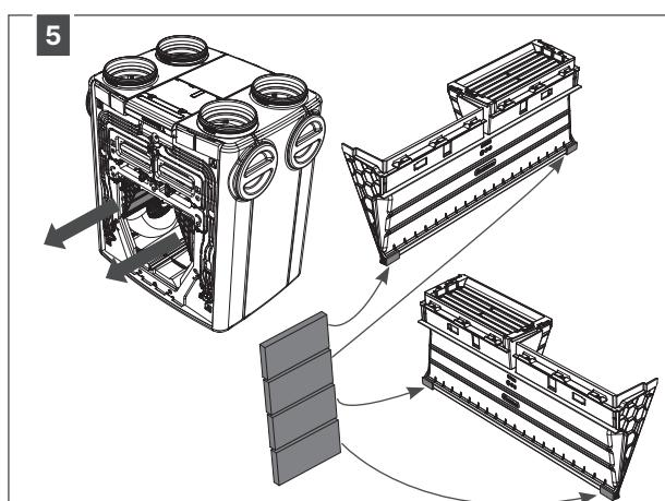
Plak een zelflevende mousse op de aangegeven plaatsen van de bypass kleppen en monteer deze terug in het toestel.
