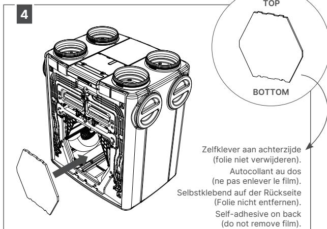
De reeds gemonteerde mousse blijft op zijn plaats zitten en de nieuwe mousse wordt eenvoudig weg toegevoegd aan het toestel.
